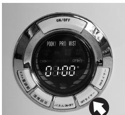
OFFタイマーは自動的に電源をOFFにする機能です。OFFタイマーボタンを一回押すと、01:00Hとディスプレイが点灯します。1時間単位で最大24時間までセットすることができます。
