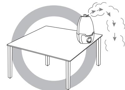
霧の落下を遮るものがある状態で噴霧すると、その面が濡れるだけでなく、本機が霧(ミスト)を再吸入し、本体内部の電気部品がダメージを受けることがあります。
