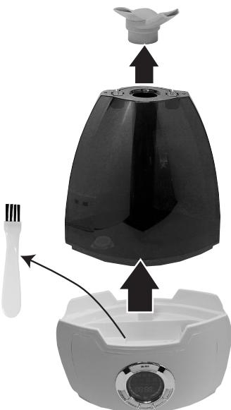
3.キャップを反時計方向に回し、キャップを外します。
