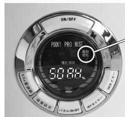
タンクに次亜塩素酸水がなくなると、ディスプレイに給水ランプ(液剤切れ)が表示され、3回ブザー音が鳴り、自動的に超音波振動子の運転が止まりミストの発生を停止します(送風はしばらく継続した後に停止します)。本体電源は入った状態を維持します。
