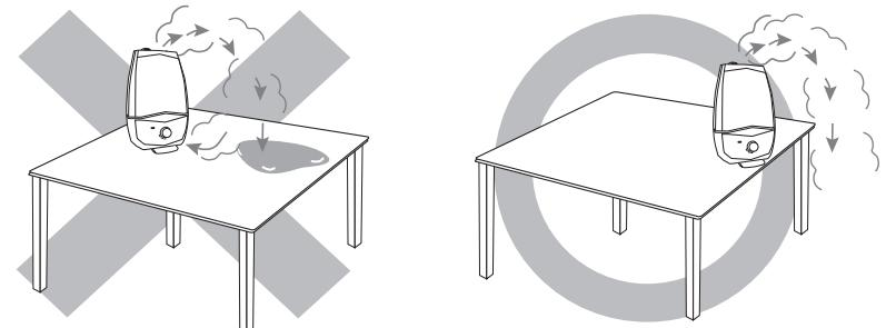
霧の落下を遮るものがある状態で噴霧すると、その面が濡れるだけでなく、本機が霧（ミスト）を再吸入し、本体内部の電気部品がダメージを受けることがあります。
